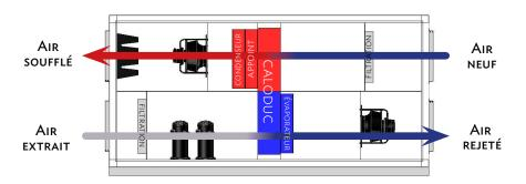
L'échangeur statique caloduc effectue un premier transfert de chaleur de l'air extrait vers l'air neuf, sans consommation d'énergie. La pompe à chaleur en refroidissant l'air extrait par son évaporateur, assure un second transfert de la chaleur prélevée, restituée à l'air neuf par son condenseur. Contrairement aux autres pompes à chaleur air-air, plus l'air extérieur est froid, plus l'efficacité de la BORA est grande.
