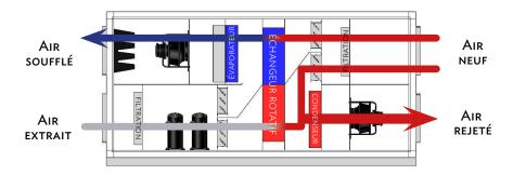
Lors des besoins d'air neuf hygiénique, un pré-refroidissement est effectué en récupérant une partie des calories de l'air neuf grâce à l'échangeur rotatif pour être transférées sur l'air traité. Le système frigorifique assure le soufflage du mélange air neuf - air extrait recyclé, refroidi selon les besoins. La chaleur prélevée à l'évaporateur (en bleu) est évacuée par le mélange air extérieur - air extrait au passage du condenseur (en rouge).
