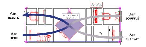
Lors des phases de dégivrage de l'évaporateur (côté air rejeté), les compresseurs sont à l'arrêt (dégivrage passif) et la batterie électrique remonte la température de soufflage.
