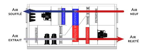
En partie basse, l'air extrait traverse l'échangeur rotatif qui réalise un pré-refroidissement de l'air neuf introduit.
