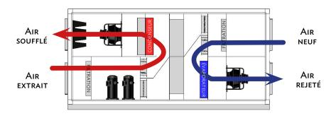
Le fonctionnement s'effectue en recyclage total de l'air des locaux, sans apport d'air neuf. Le système prélève alors uniquement la chaleur de l'air extérieur.
