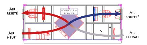
En partie basse, l'air extrait traverse l'échangeur à plaques qui réalise un pré-refroidissement de l'air neuf introduit. Un refroidissement complémentaire est assuré par la thermodynamique permettant ainsi de souffler à température neutre.
