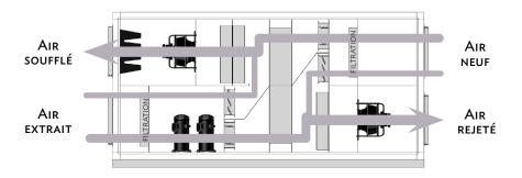
Rafraîchissement gratuit par apport d'air neuf frais en proportion variable du mini jusqu'à 100%. Compresseurs à l'arrêt. Ce mode de fonctionnement permet de réaliser d'importantes économies d'énergie électriques.
